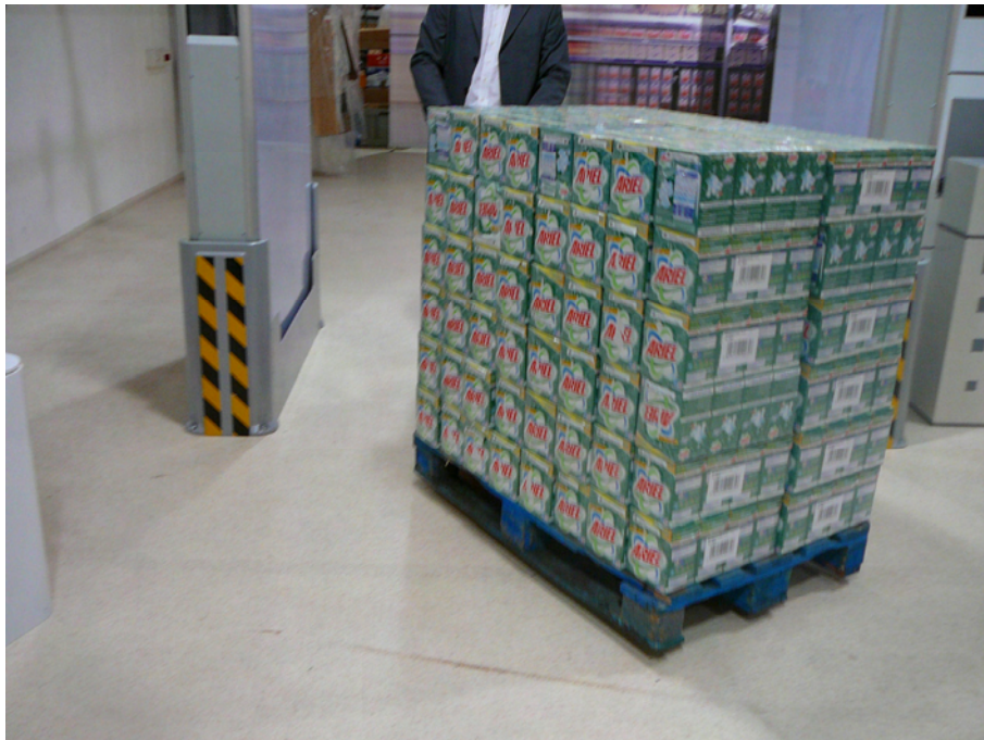
写真4-46 ゲートリーダーによるアイテムレベルの読み取り
