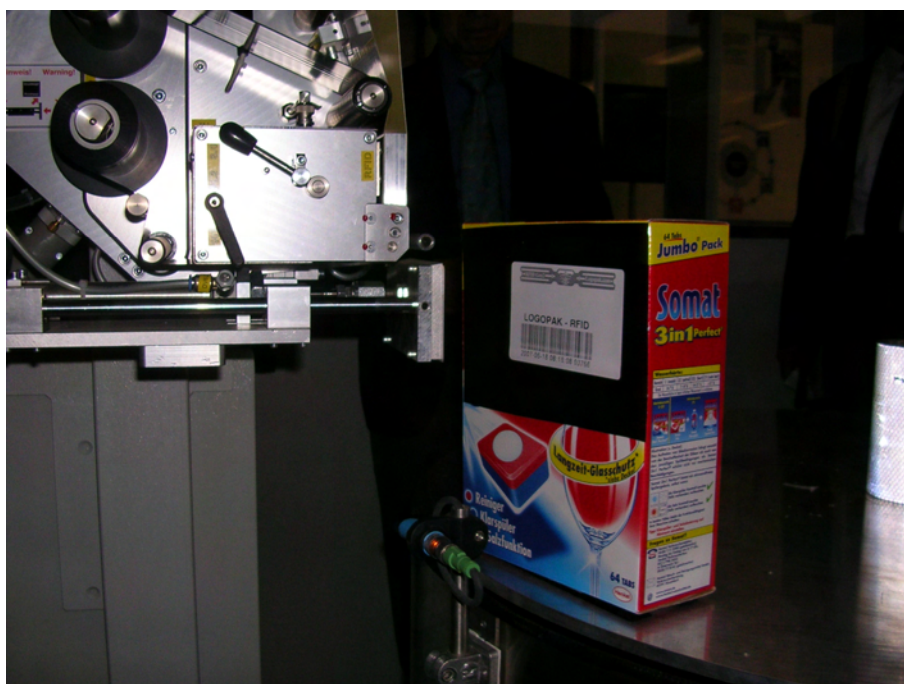
写真4-4 2 空気圧によるタグの装着
