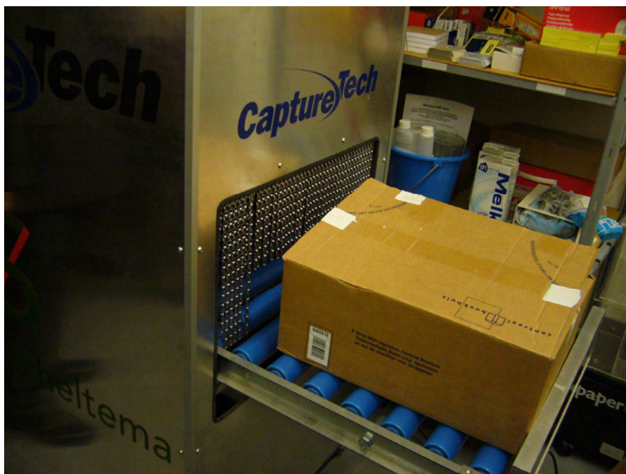
写真4-1 3 トンネルリーダによる入荷検品
