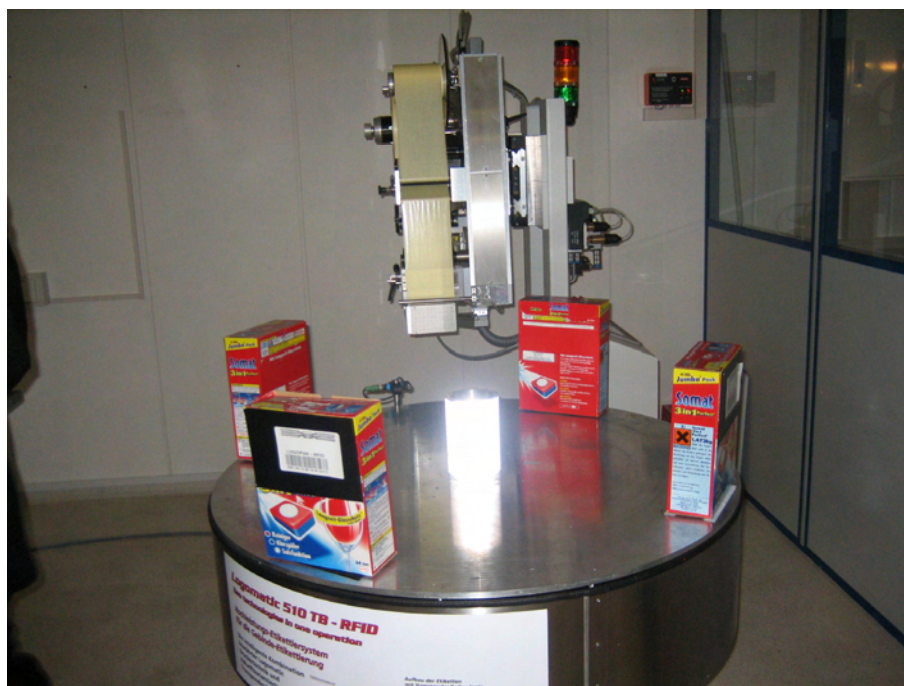
写真4-4 1 商品へのタグ装着機械
