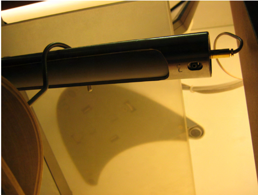
写真4-52 ハンガー下の商品のみを読み取るよう工夫されたアンテナ
