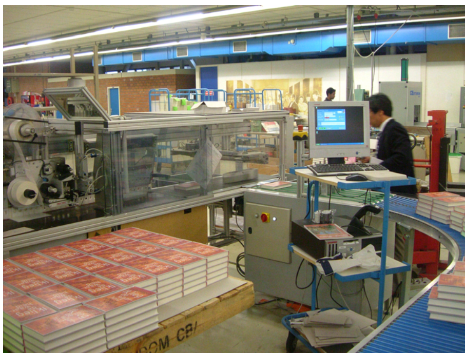
写真4-27 タグの自動装着機
