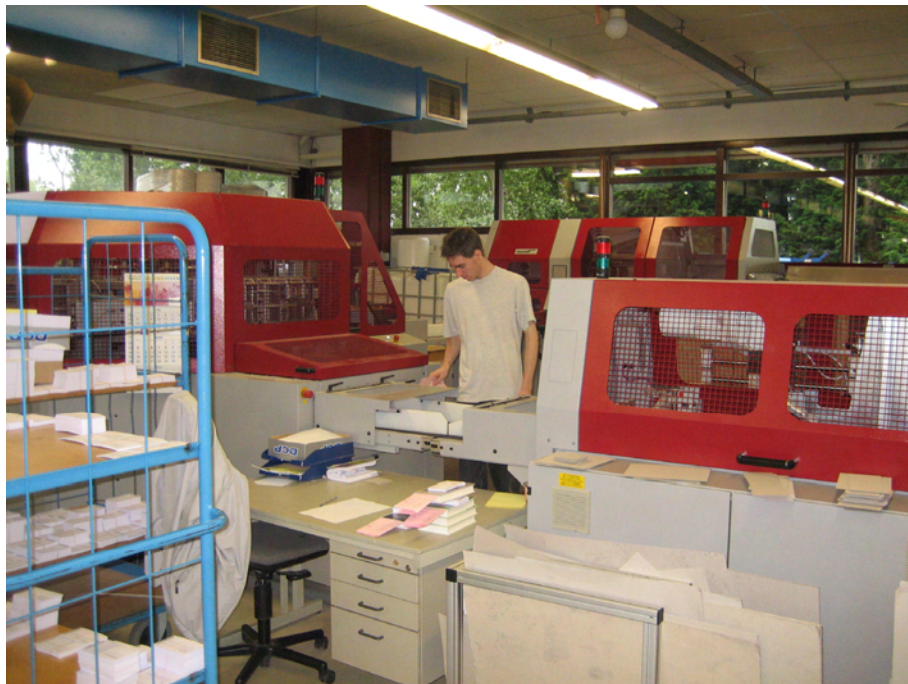
写真4-35 ハードカバーへの再製本用の製本機
